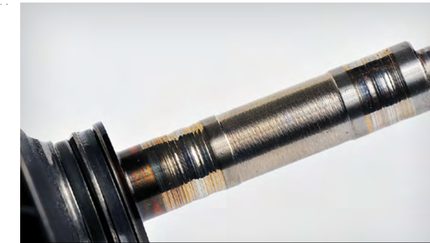
Aşınmış ve sıyrılmış yatak. Mille malzeme taşınması
