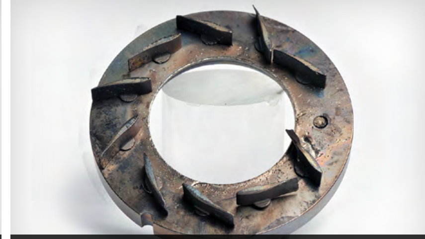
Nozul tertibatında hasar
