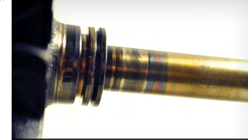
Yüksek sıcaklık ve yatağa malzeme taşınması
