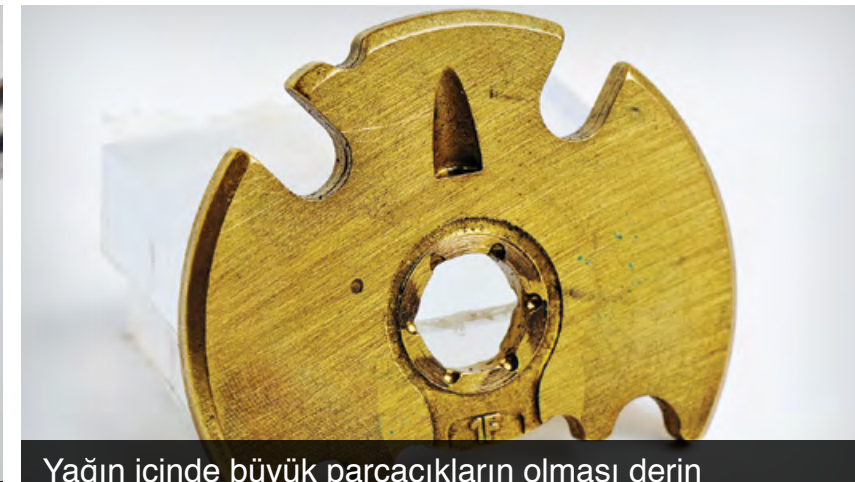
Yağın içinde büyük parçacıkların olması derin sıyrıklara ve etkilere yol açabilir
