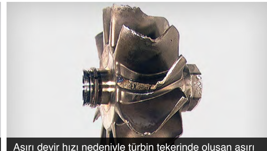
Aşırı devir hızı nedeniyle türbin tekerinde oluşan aşırı çalışma arızası
