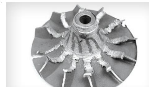
Danno a una ruota del compressore
