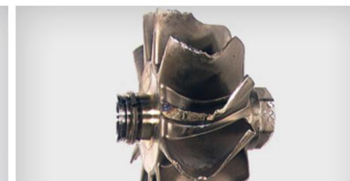
Ruota della turbina con guasto da fatica dovuto a sovravelocità ciclica
