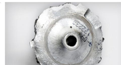
L'effetto a buccia d'arancia sulla parte posteriore della ruota del compressore è un chiaro segno di sovravelocità.
