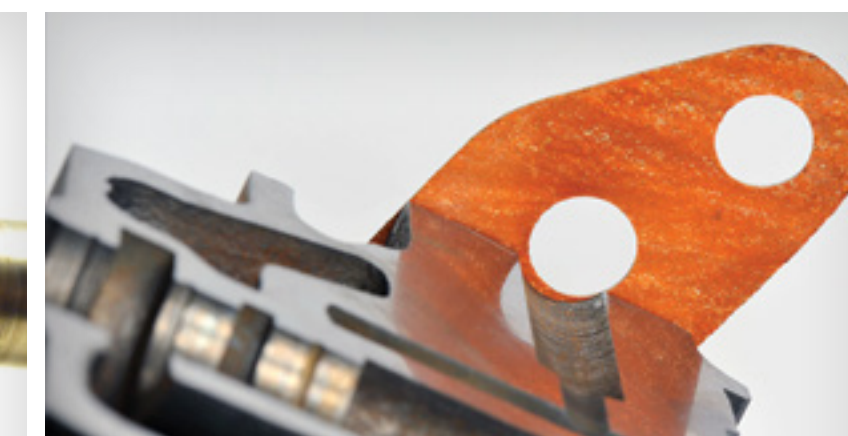
Forme et positionnement des joints inappropriés
