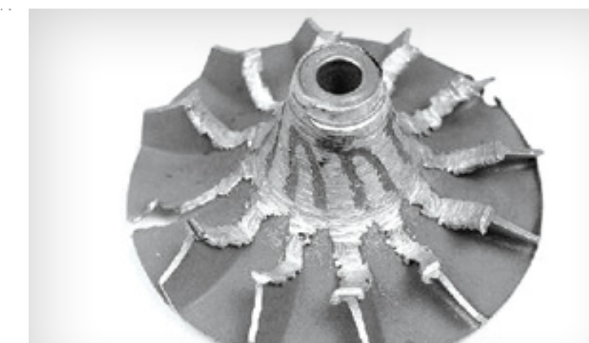
Panne d'une roue compresseur
