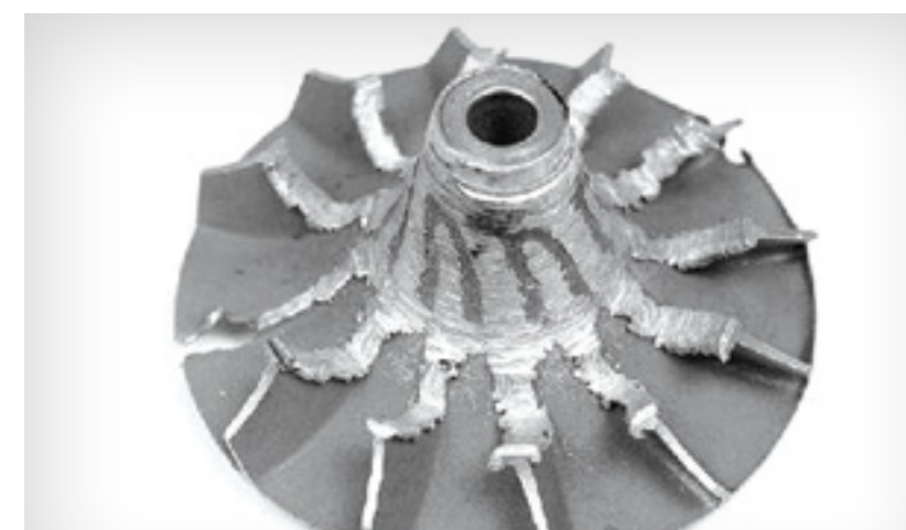
Rueda del compresor deteriorada
