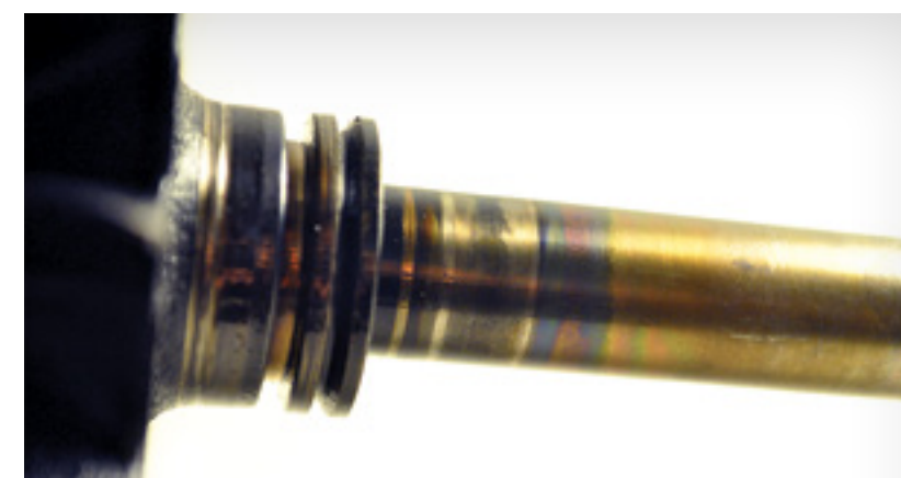
Apoyo sometido a alta temperatura y transferencia de materiales
