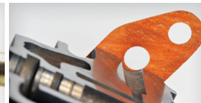
Junta deformada y mal colocada
