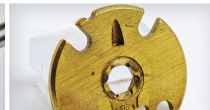
Las partículas de gran tamaño en el aceite pueden causar desgastes y golpes profundos
