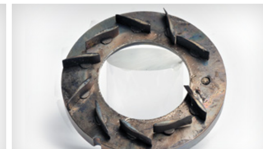
Conjunto de toberas deteriorado
