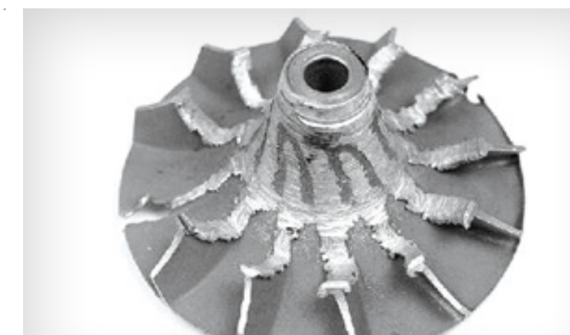
Schaden an einem Verdichterrad
