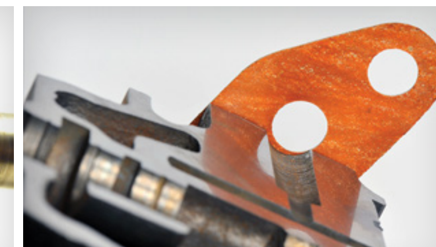
Falsche Form und Einbaulage der Dichtung
