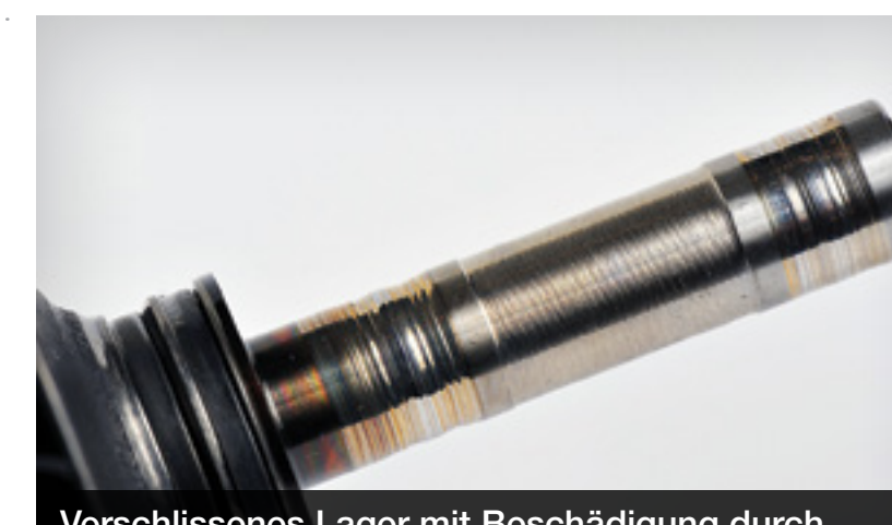
Verschlissenes Lager mit Beschädigung durch Riefen. Materialtransfer zur Welle
